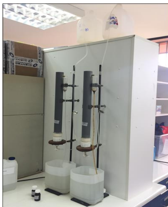
Fig. 2: Biolixiviación en micro columnas inversas. (Fuente: Elaboración propia).
